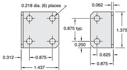
**Montaje:** Seis orificios de 7/32" de diámetro en centros de 1/8" para montar las válvulas al soporte
