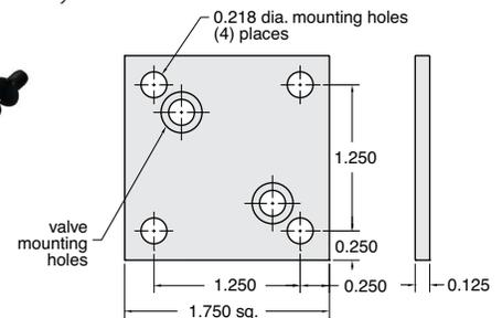
Terminación en negro anodizado, se proporcionan dos tornillos de montaje
